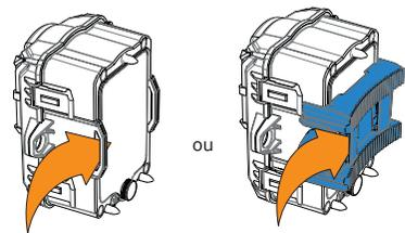
lorsque la caméra est installée à l'aide du socle de fixation, elle peut être retirée afin d'accéder au compartiment des piles sans déranger l'installation.
