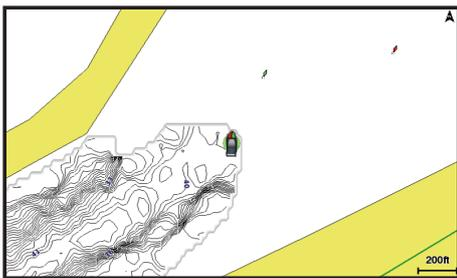
La capture d'écran montre la création d'un relevé bathymétrique en temps réel sur une zone où il n'y avait aucun détail.
