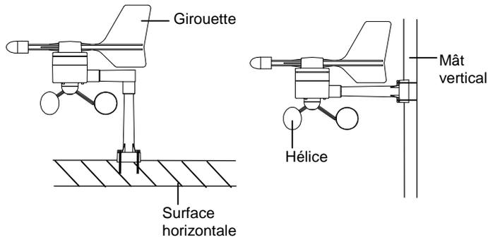
Avant de fixer l'anémomètre, vérifiez que l'hélice et la girouette tournent sans entrave. Pour obtenir des relevés précis, il est important de fixer le capteur de telle façon que l'avant (repère E) soit dans l'axe Est-Ouest. Fixez l'anémomètre sur un mât ou une surface horizontale solide à l'aide d'une attache en nylon ou de vis, de façon à ce que le vent puisse circuler tout autour sans obstacle (diamètre recommandé du mât : entre 16 mm et 33 mm).
