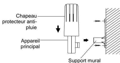
L'emplacement idéal pour le transmetteur Thermo-hygro se situe sur un mur extérieur, sous l'avant-toit, ce qui le protégera du soleil, de la pluie et d'autres intempéries.
