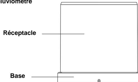
Pour une utilisation optimale, installez le pluviomètre sur une surface strictement plane, à une hauteur de 1 mètre du sol, à l'écart de toute obstruction possible, tel que sous un arbre ou à couvert, les données seraient faussées.
