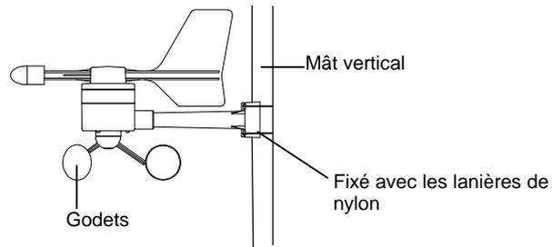
1. Déverrouiller le support de l'anémomètre en laissant le fil passer par le support.
