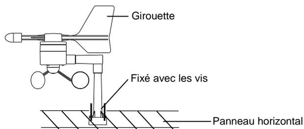
1. Déverrouiller le support de l'anémomètre en laissant le fil passer par le support.
